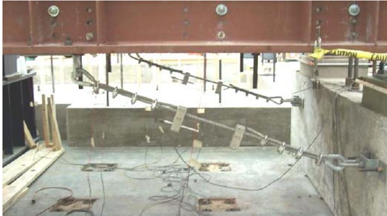
شکل ۴-۸۶- آزمایش‌های تمام مقیاس روی مقیدکننده‌های کابلی فولادی [۶۷].
